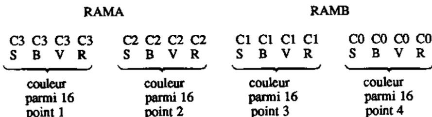
Pour ce mode (CBA = 011), le gate array d'affichage effectue un transcodage (T1 T0 = 11) selon le schéma:
