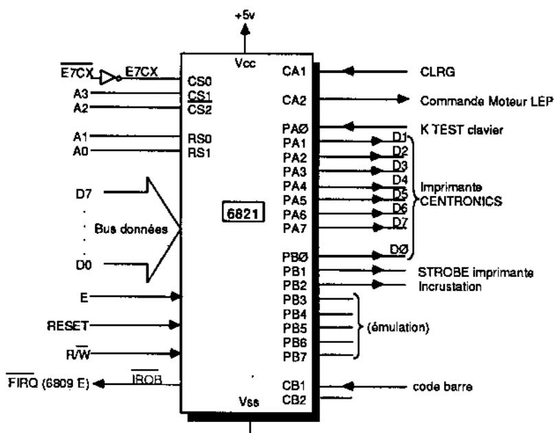
Figure 23. Le 6821 "système" dans le TO8
