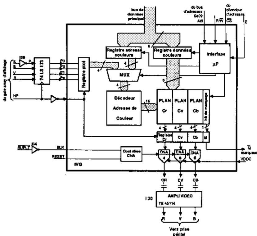
Figure 9. Circuit de palette. Utilisation de l'ITVG 9369
