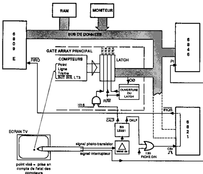
Figure 14. Synoptique du fonctionnement du crayon optique dans le T09
