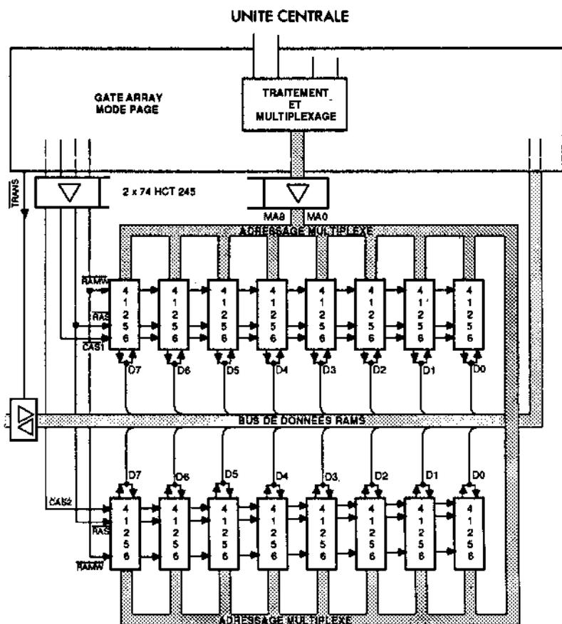
Figure 28. Système de mémorisation RAM dans le TO9+
