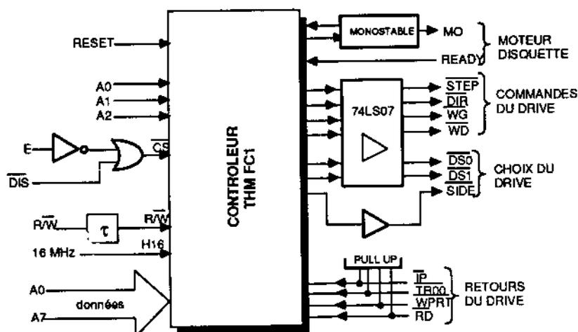
Figure 26. Le gate array contrôleur de disques
