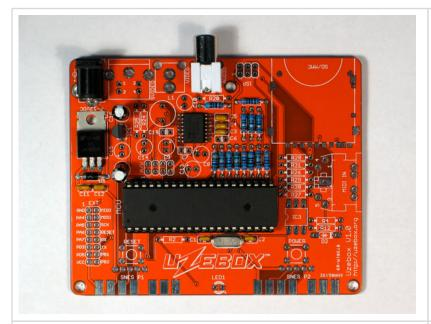
Assemble the video DAC by soldering  $\it{R1}(3.16 \rm{K}\Omega)$ ,  $\it{R5}(1.58 \rm{K}\Omega)$ ,  $\it{R6}(806 \rm{\Omega})$ ,  $\it{R8}(3.16 \rm{K}\Omega)$ ,  $\it{R9}(1.58 \rm{K}\Omega)$ ,  $\it{R10}(806 \rm{\Omega})$ ,  $\it{R17}(1.58 \rm{K}\Omega)$ ,  $\it{R18}(806 \rm{\Omega})$  and  $\it{C3}(100 \rm{nF})$ ,  $\it{C4}(100 \rm{nF})$ ,  $\it{C5}(100 \rm{nF})$ .
