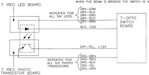
THE BALL ROLLS BETWEEN THE LED BOARD AND THE PHOTO TRANSISTOR BOARD BREAKING THE BEAM. WHEN THE BEAM IS BROKEN THE SWITCH IS MADE.
